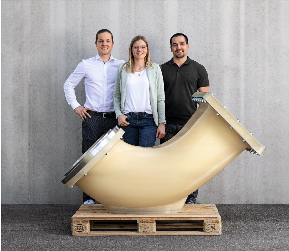
Gründer von Q.BIG 3D – Dennis Herrmann, Katja Schlichting, Michael Heel Bauteil: Ansaugkrümmer / Projekt mit der Firma Voith GmbH & Co. KG Material: PLA / Druckdauer 340 Stunden / Druckgewicht 205 kg
